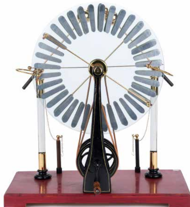
Elektriseermachine van Wimshurst, ca. 1900, De Museumfabriek
